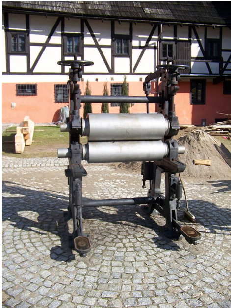
XVII-wieczny kalander papierniczy, przeznaczony do gładzenia wysuszonego już papieru czerpanego – Muzeum Papiernictwa w Dusznikach-Zdroju (źródło: Papier ( Wikipedia ))
